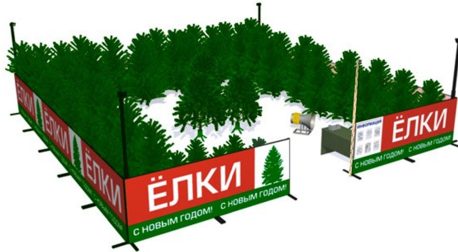
Конструкция для временного размещения товарного запаса нестационарного торгового объекта «Елочный базар» - сборно-разборная в виде декоративного ограждения, обтянутого по периметру баннером, оформленном в новогоднем стиле.
